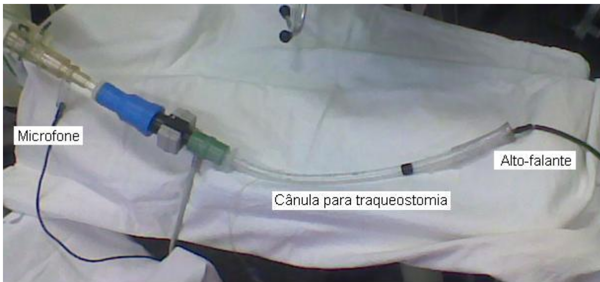
Figura 27 – Foto do ensaio realizado para avaliar a propagação do som nos tubos utilizados durante o experimento com animais. O microfone foi posicionado entre o tubo do ventilador respiratório e o sensor de PCO 2 , e o alto-falante foi fixado no final da cânula de 30 cm, utilizada na traqueostomia.
