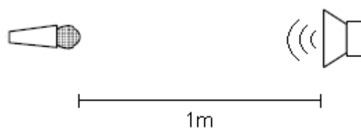
Figura 24 - Arranjo experimental para avaliação da sensibilidade e resposta em frequência dos microfones.
