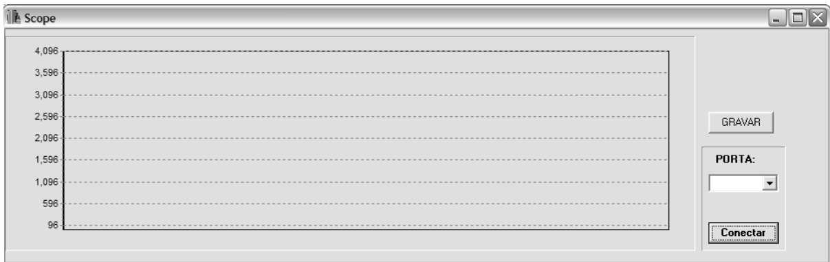
Figura 18: Tela do programa Scope contendo áreas de plotagem do gráfico de pletismografia e de configuração da comunicação serial e um botão para início da gravação dos dados
