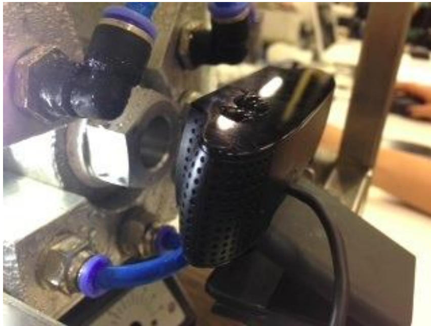
Figura 18: Detalhe da iluminação da Célula de Equilíbrio de Fases. Em (a) Janela de Safira Lateral e em (b) detalhe da captura de imagens do sistema via webcam.
