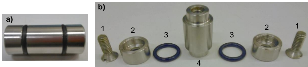
Figura 10 - Esquema do pistão montado (a) e do pistão desmontado (b) com parafuso (1), rosca (2), anel de Buna N90 (3) e corpo do pistão (4).
