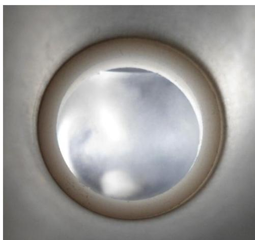
**Figura 12:** Vista da célula de equilíbrio de fases durante a transição fluido - líquido
