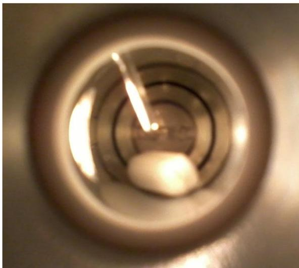
**Figura 8:** Vista da célula de equilíbrio de fases ao atingir um sistema monofásico
