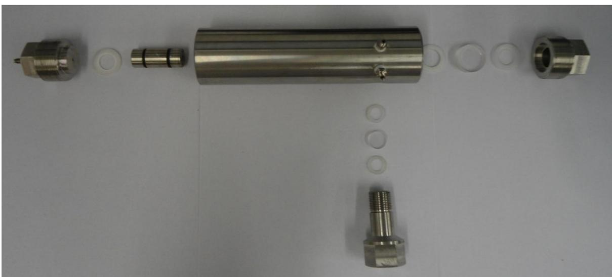
**Figura 6:** Montagem da Célula de Equilíbrio
