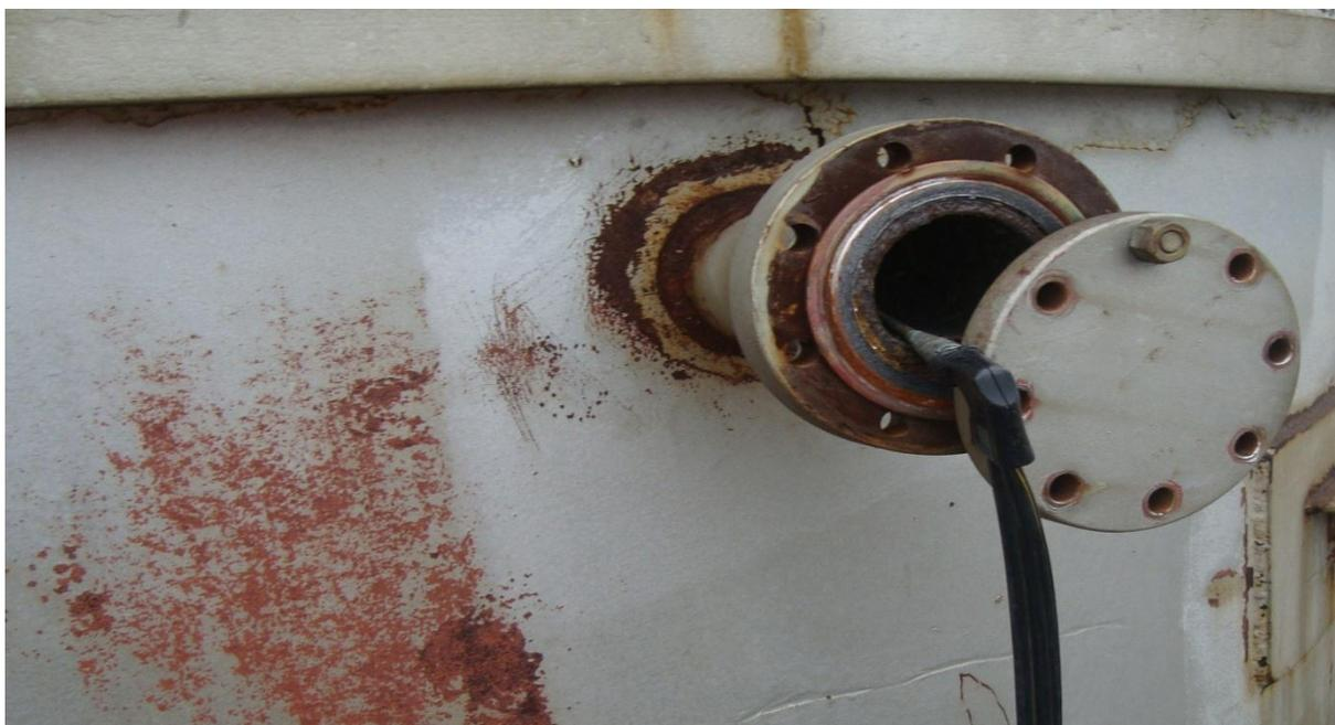
**Figura 13: Sonda Inserida no Ponto de Amostragem**
