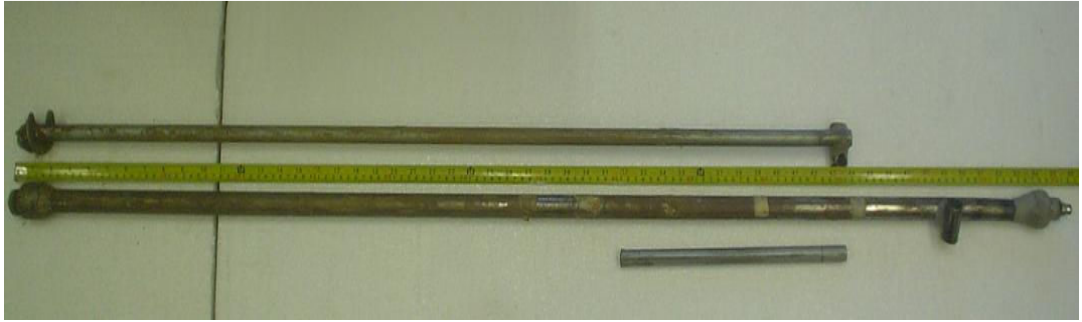
Figura 43. Foto da broca, sonda e haste
