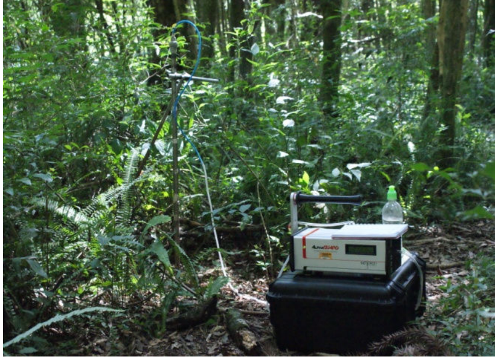
Figura 51. Medição do ^{222}\text{Rn} no solo região Jardim Botânico
