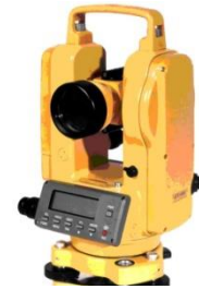
Figura O: Teodolito, instrumento usado para medir ângulos.
