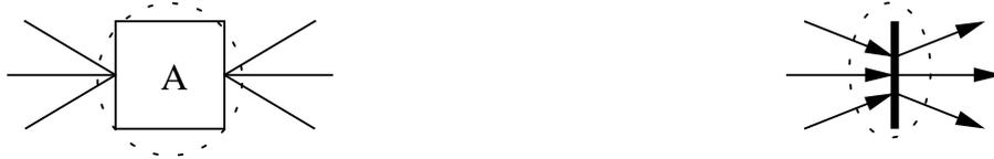
Figura 3.6: Tradução de um nó ação em uma transição na RdP.
