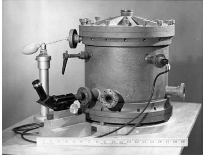
Figura 10: Aparelho utilizado por Millikan para a determinação da carga elétrica (Retirado de <http://profs.ccems.pt/PauloPortugal/PHYSICA/Millikan/millikan.htm>.)
