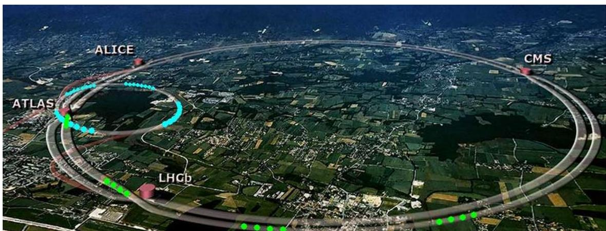
Figura 44: Fotografia do LHC, ou o Grande Colisor de Hádrons, na Suíça. É um Acelerador tipo Colisor. Extraído de <http://physicsact.wordpress.com/2007/10/29/lhc-grande-colisor-de-hadrons>.
