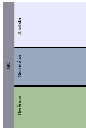
Figura 9: Representação dos elementos de piscinas e raias do BPMN
