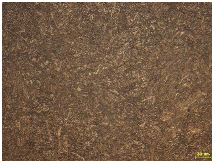
Figura 3. 1 – Microestrutura martensítica revenida. Fonte: Laboratório metalográfico Robert Bosch.
