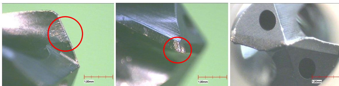
Figura 9. Análise de desgaste da broca com parâmetros comerciais (O autor).
