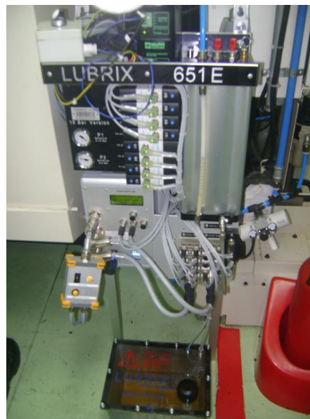
Figura 3. 2 – Sistema de lubri-refrigerante MQL.
