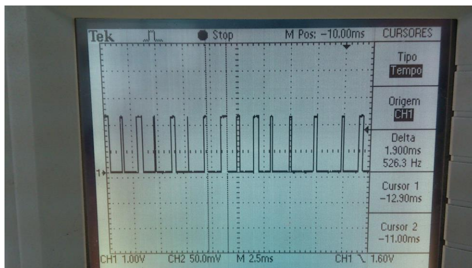
Figura 26: Sinal de interrupção do acelerômetro. Fonte: Autoria própria.
