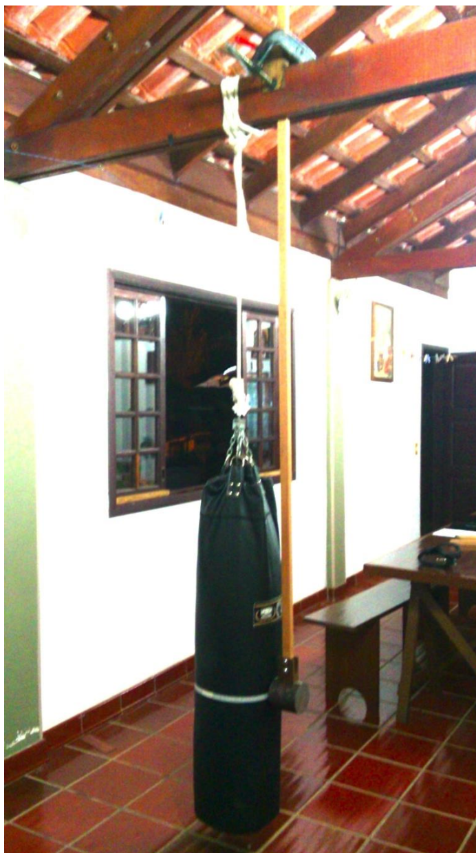
Figura 46: Posição de impacto do sistema saco-pêndulo. Fonte: Autoria própria.
