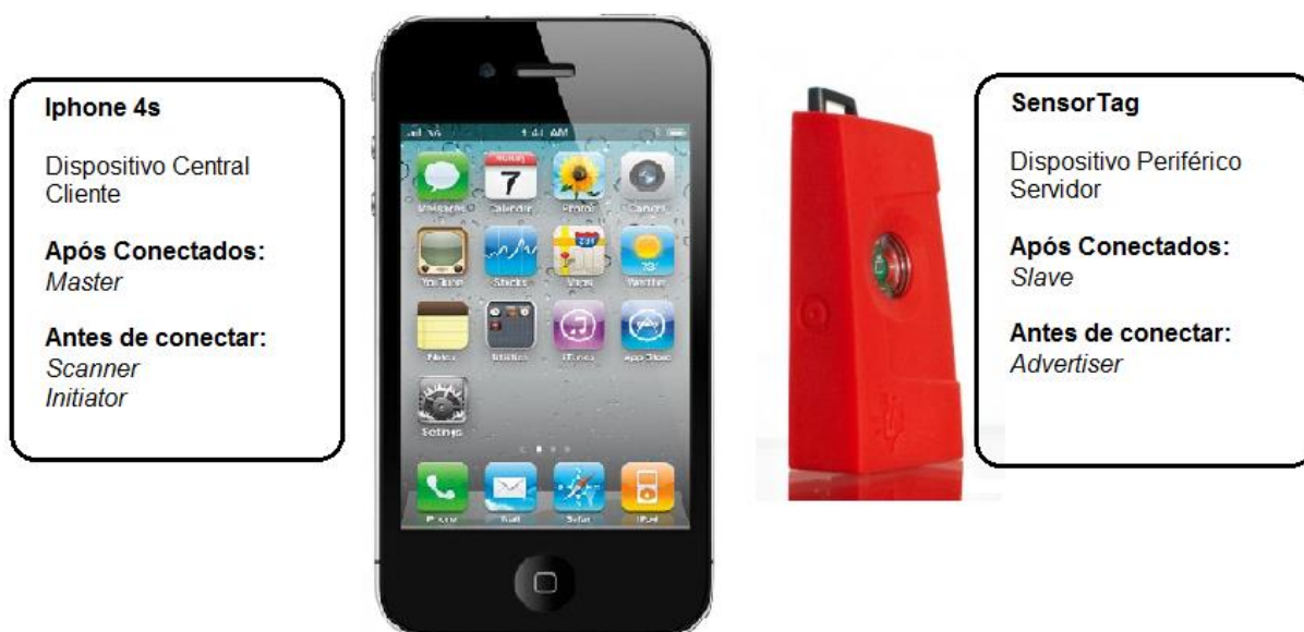
Figura 18: Papéis do iPhone e do SensorTag numa conexão BLE. Fonte: Autoria própria.
