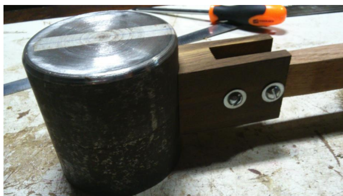
Figura 45: Massa fixada na haste do pêndulo. Fonte: Autoria própria.
