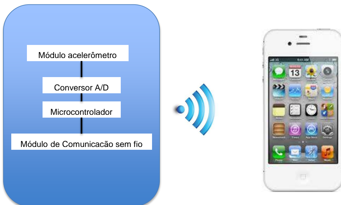
Figura 1: Diagrama do sistema de monitoramento de golpes. Fonte: Autoria própria.
