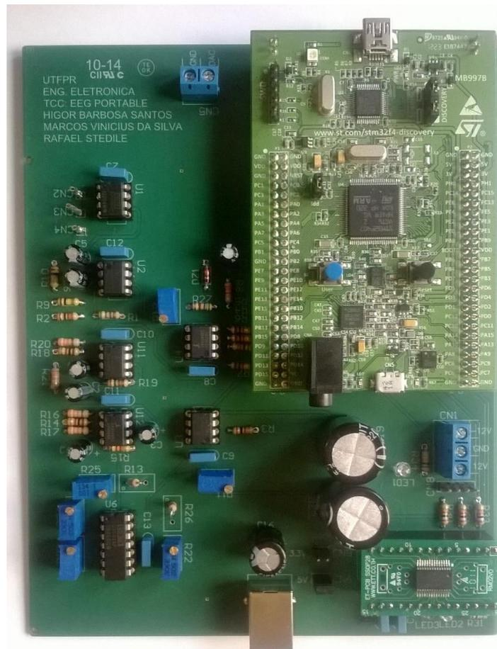
Figura 31 - Placa do EEG Portátil
