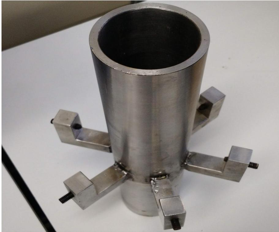
**Figura 17: Cilindro de Aço com Suporte para os Transdutores.**
