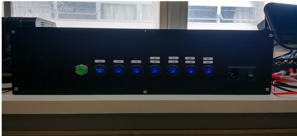
**Figura 22: Painel Frontal do Chassis. O sistema é ligado e desligado pressionando o botão verde. Os botões azuis servem apenas como uma indicação luminosa para o estado das linhas de tensão.**
