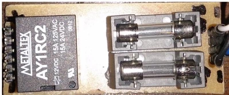
Figura 18 - Circuito de distribuição de tensões SW-R2F12V
