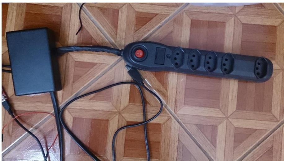
**Figura 46 - Filtro de linha do quarto grande com placa de optoacopladores SW-I5OP.**
