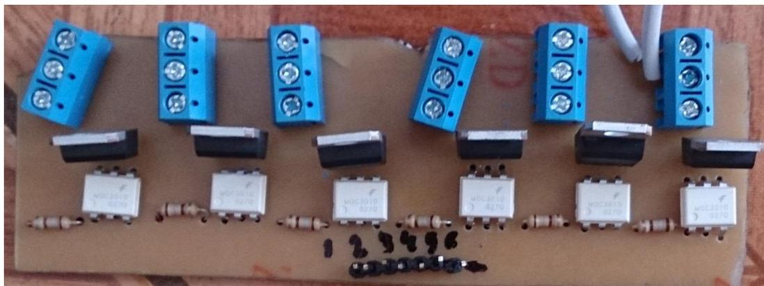
**Figura 27 - Placa SW-R6OP montada**
