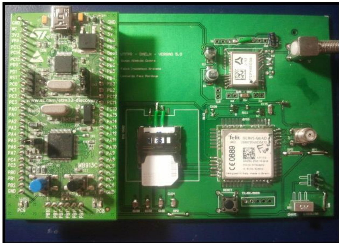
Figura 26: Placa prototipada, módulos GPS, GPRS e kit embarcados
