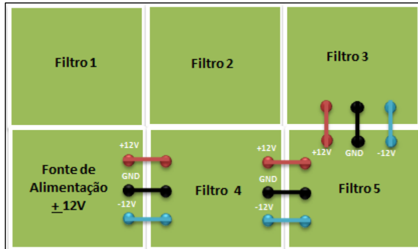
Figura 77 – Alimentação do filtro 3 por intermédio de outras placas. Fonte: Autoria própria (2004).
