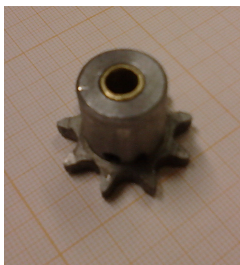
Figura 28 – Coroa menor do sistema de transmissão. Notar embuchamento de latão para o eixo do motor. Fonte: Autoria própria.
