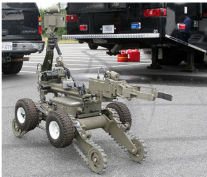
Figura 2 – Robô de remoção de explosivos (EOD) da polícia norte-americana. Fonte: Scientific American Blogs 10 .
