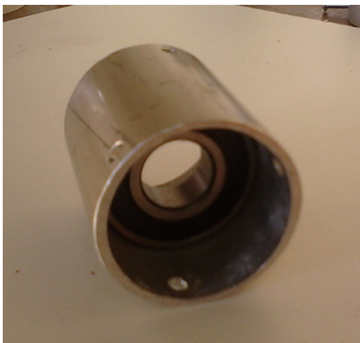
Figura 18 – Cubo com rolamento instalado. Fonte: Autoria própria.
