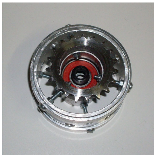
Figura 29 – Roda de tração com coroa maior. Fonte: Autoria própria.
