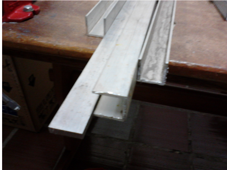
Figura 5 – Cantoneiras de alumínio; material básico do chassi. Fonte: Autoria própria.
