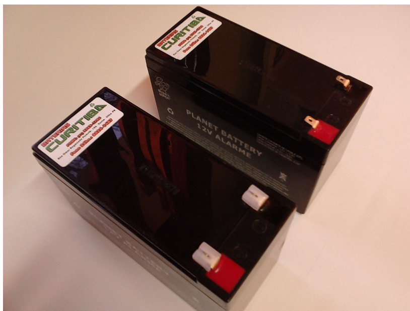
Figura 40 – Baterias de alimentação do veículo. Fonte: Autoria própria.
