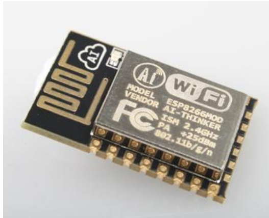
Figura 3 - Módulo ESP12-E Fonte: AI-Thinker
