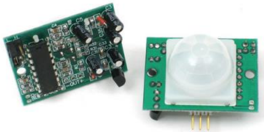
Figura 8: Módulo sensor PIR Fonte: PIR Motion Sensor (Adafruit, 2017, p. 3)
