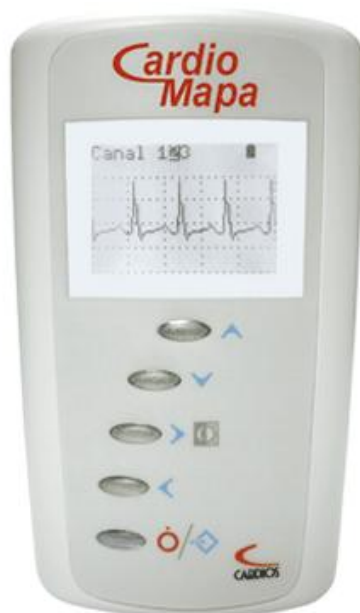
Figura 37 - Holter da empresa Cardios – CardioMapa Autor: (CARDIOS - EQUIPAMENTOS AVANÇADOS EM ELETROCARDIOGRAMA E MAPA, 2013)
