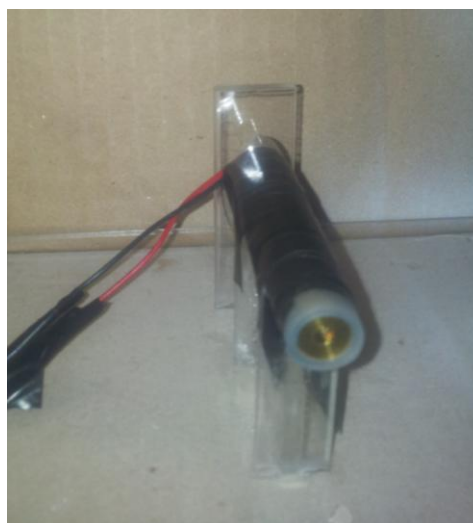
Figura 27- Módulo laser utilizado com fonte luminosa do sistema Fonte- O autor (2013)
