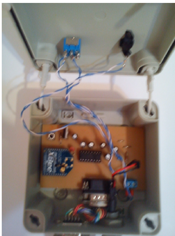
Figura 49 - Circuito do módulo de recepção
