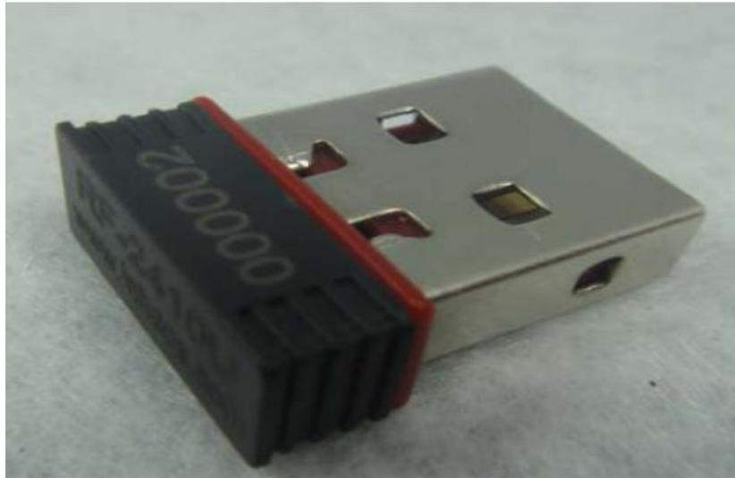
**Figura 11: Estrutura física do RF-2410U**
