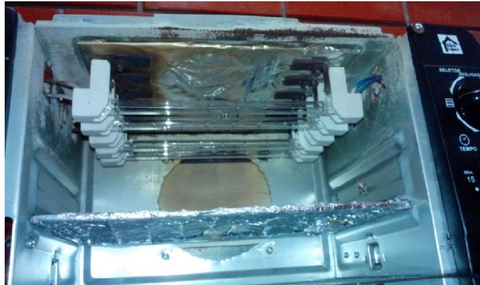
Figura 40 - Substituição das resistências por lâmpadas
