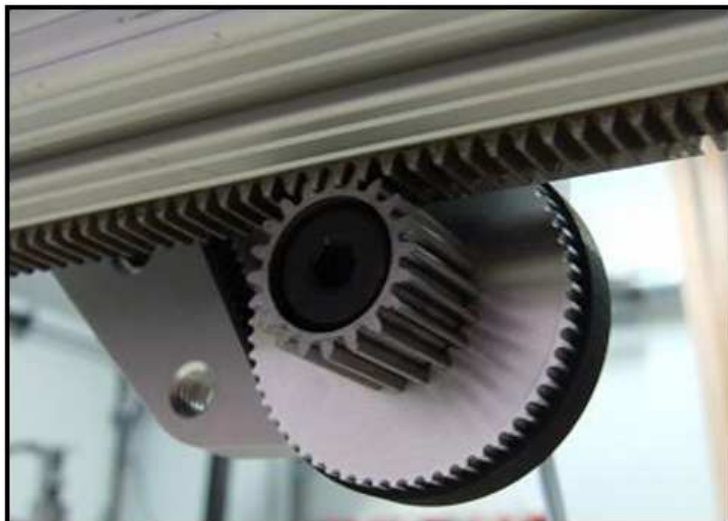
Figura 10 - Sistema de posicionamento que utiliza cremalheira acoplada aos motores para conversão de movimento gerado pelos motores.
