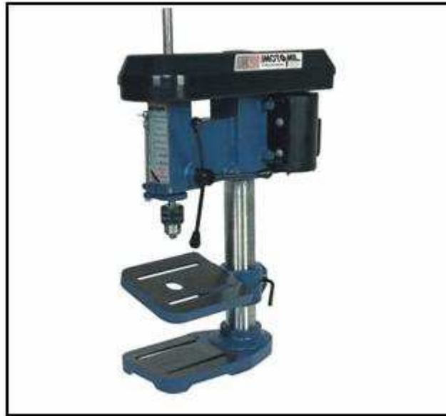
Figura 6 – Furadeira de bancada típica. Fonte: ACamargo 8 .
