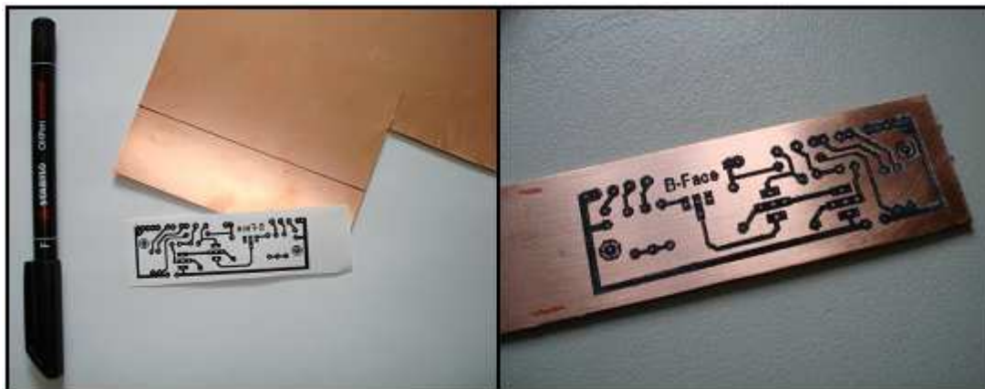
Figura 2 – Exemplo de passagem de layout de placa com papel de foto. Fonte: The Guitar Players Community 3 .
