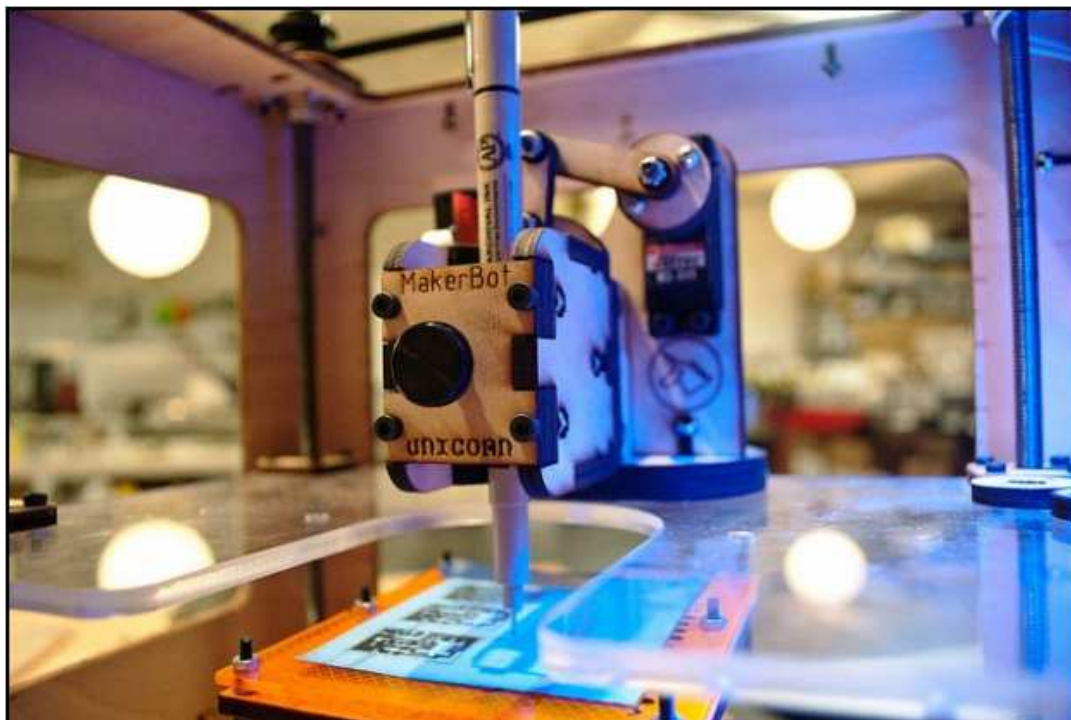
Figura 4 – Impressora 3D MakerBot® imprimindo layout de PCI. Fonte: Maker Bot 6 .
