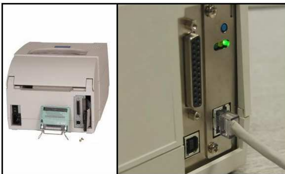
Figura 13 – Impressora de códigos de barra da CITIZEN® e suas interfaces de comunicação.
