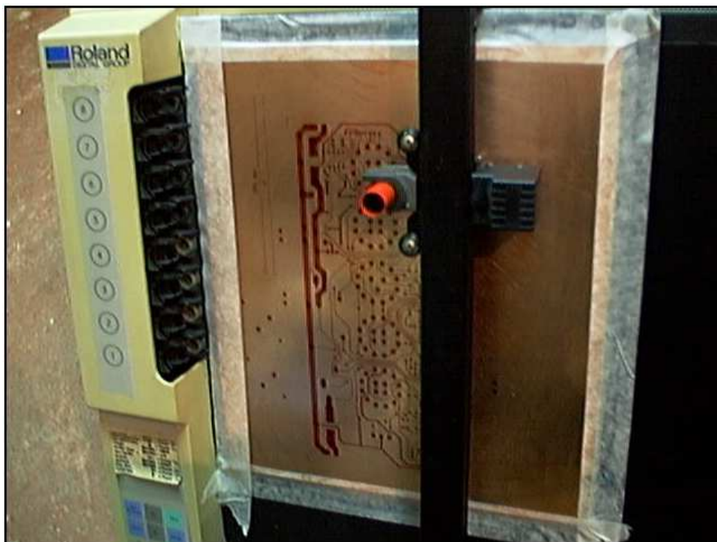
Figura 3 – Plotter comercial da Roland® sendo utilizado para desenho de uma PCI. Fonte: Will Cox Online 5 .
