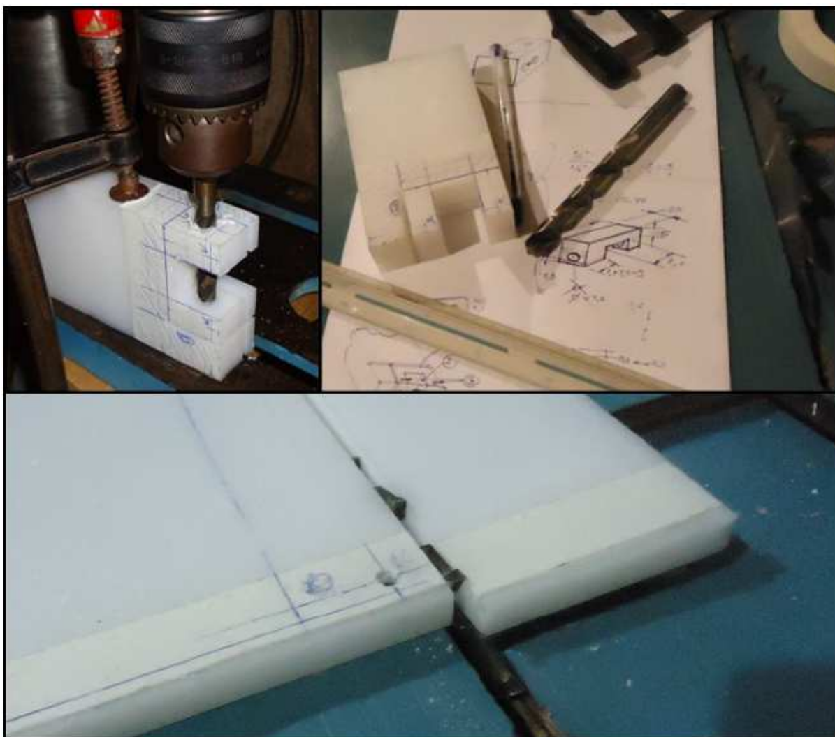
Figura 8 – Processamento de peças utilizando UHMW. Fonte: Autoria própria.
