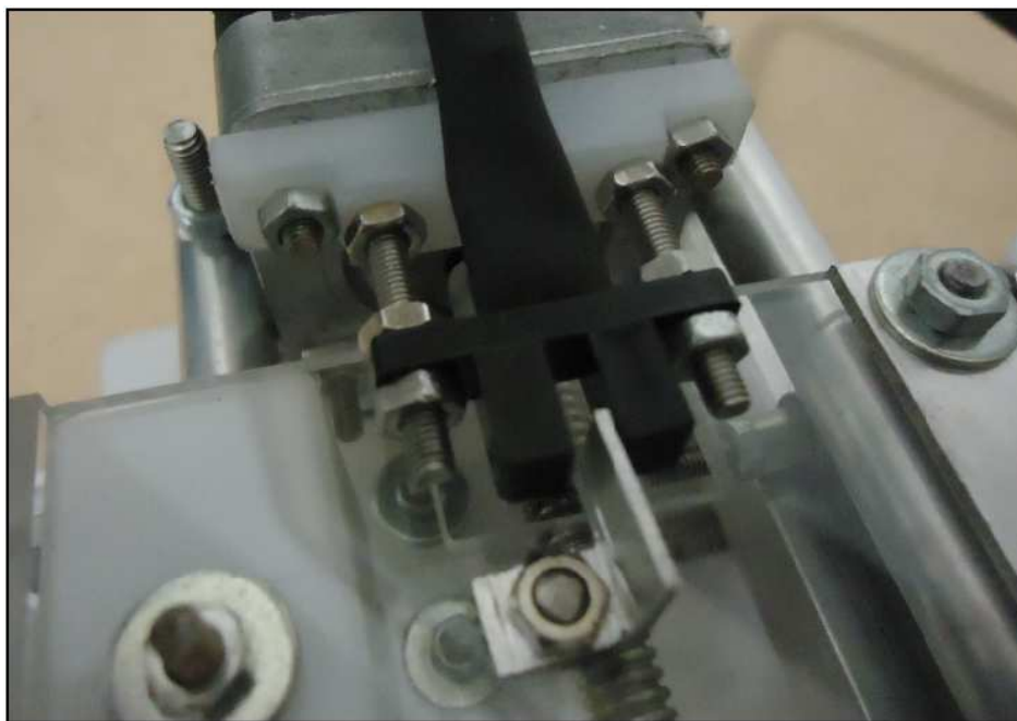
Figura 35 – Foto do acoplamento de sensor óptico em motor. Fonte: Autoria própria.
