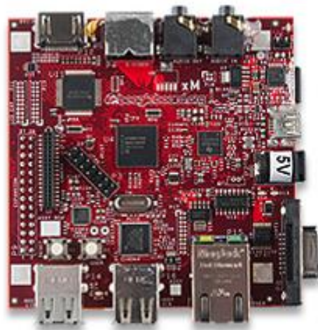
Figura 6 - Beagleboard-xM RevC: placa utilizada para desenvolvimento da central do sistema Fonte: Página da Beagleboard na Internet
