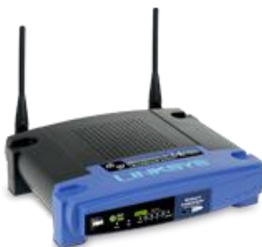
Figura 4 - Roteador utilizado para interfacear as câmeras, a central e o computador pessoal do usuário Fonte: Página da Cisco Linksys na Internet
