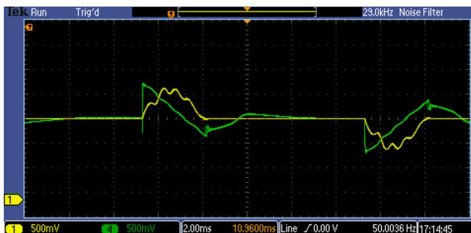
Figura 2 – Sinais de tensão e corrente para circuito com 10 lâmpadas sem falhas. Fonte: Autoria própria
