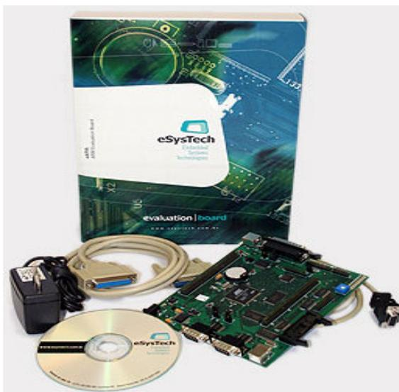
**Figura 3: Kit utilizado da eSysTech**
