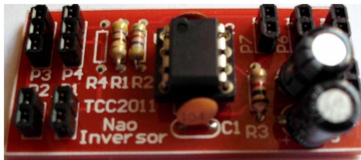
**Figura 77: Placa montada correspondente ao circuito amplificador não inversor.**
