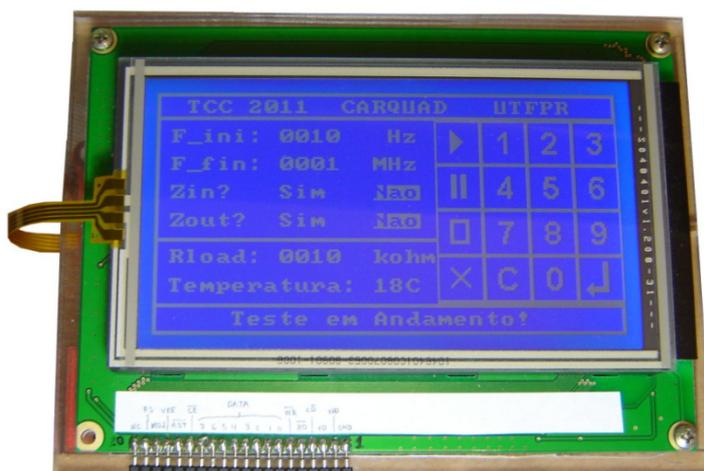
**Figura 6: Ilustração do display gráfico utilizado no projeto.**
