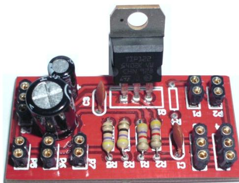
**Figura 127: Placa montada correspondente ao circuito do amplificador de potência classe A.**
