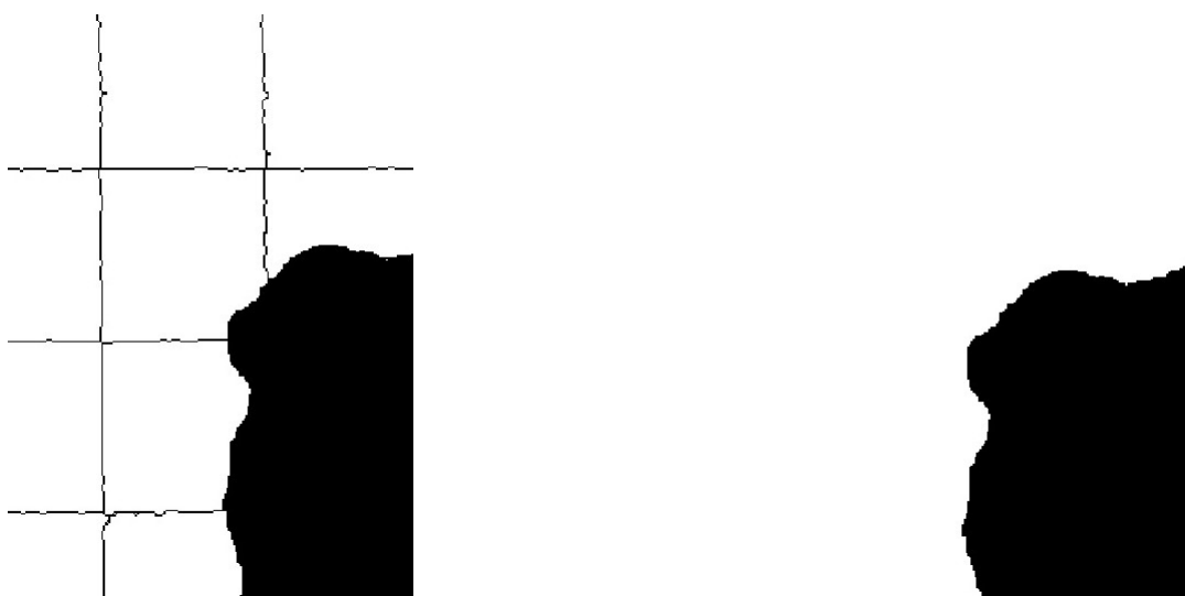
Figura 23 – Linhas que cruzam a imagem afinadas e resultado após erosão
