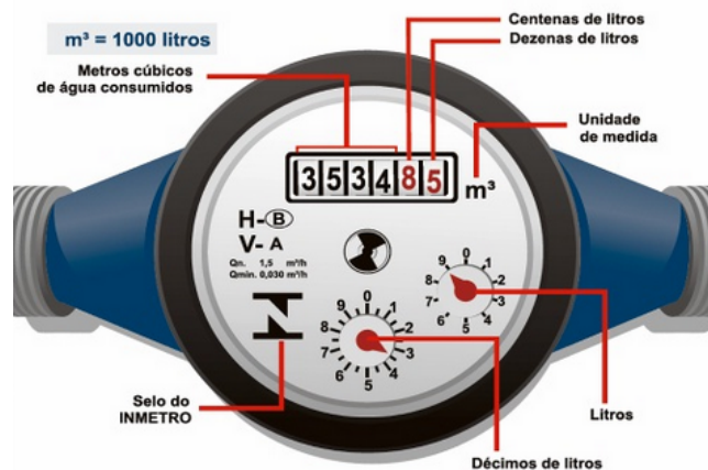
Figura 4: Marcação da leitura de consumo de água realizada em hidrômetros velocimétricos
