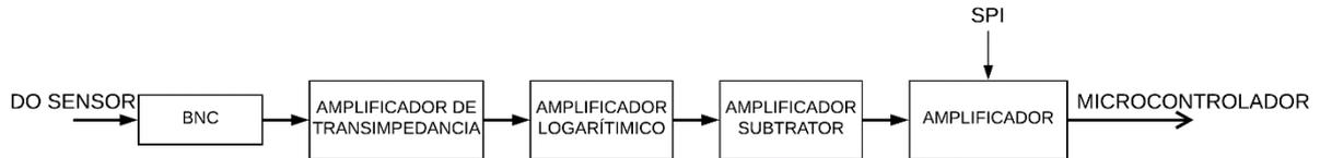
**Figura 3.6 - Diagrama em blocos do circuito de um canal de recepção**
