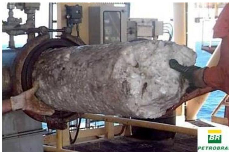
Figura 1.1 - *Plug* de hidrato removido de tubulação
