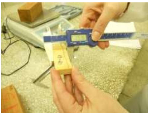
Figura 26 - Largura no meio do corpo de prova
