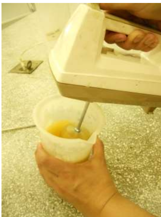
Figura 19 - Mistura do pré-polímero com o polioli com a batedeira
