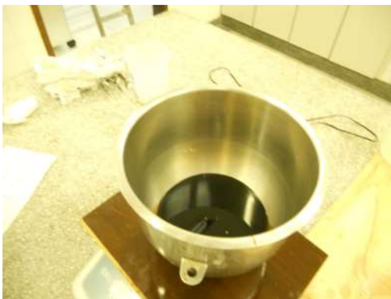
Figura 16 - Pesagem da resina à base de fenol-formaldeído
