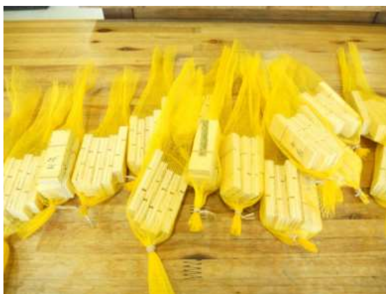
Figura 31 - Separação dos corpos de prova por painel para o pré-tratamento de fervura
