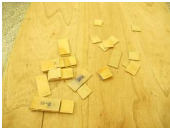
Figura 39 - Alguns corpos de prova de cisalhamento após tratamento de ciclo e fervura
