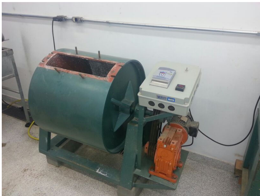
Figura 8 - Moinho de bolas utilizado na moagem do resíduo.
