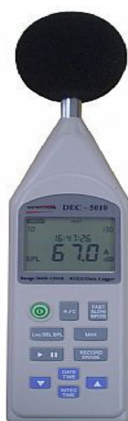
Figura 14 - Modelo de decibélímetro utilizado nas medições de ruídos.
