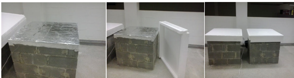
Figura 13 - Fechamento e isolamento superior dos protótipos.
