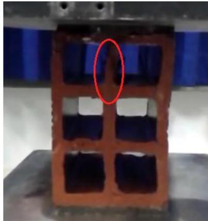
**Figura 16:** Fissuras no bloco de furação quadrada
