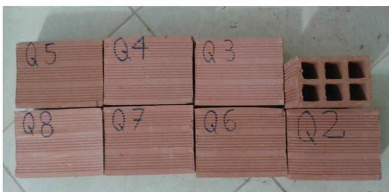
**Figura 10:** Identificação dos blocos de furo quadrado
