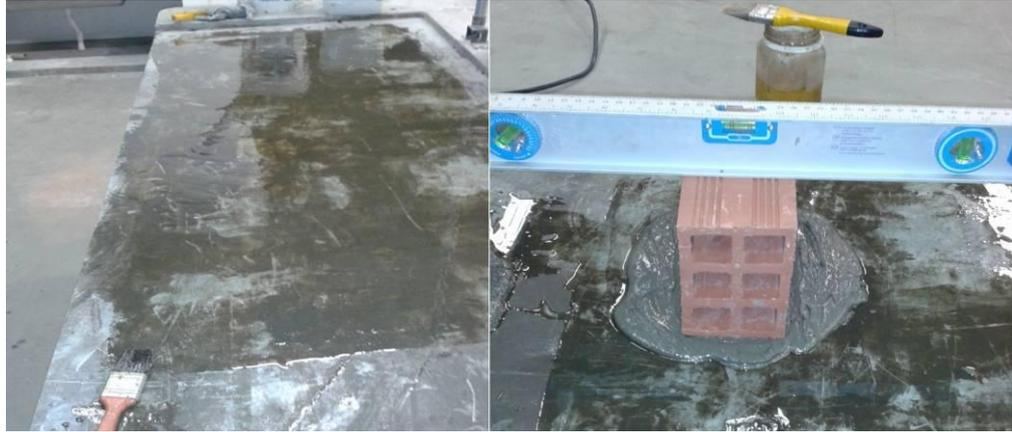
**Figura 11:** Aplicação de desmoldante e nivelamento dos blocos
