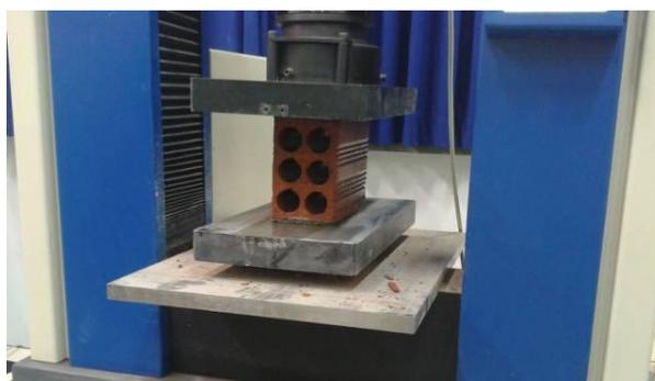
**Figura 15:** Posicionamento do bloco na prensa
