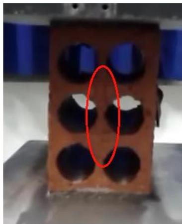
**Figura 17:** Fissuras no bloco de furação circular
