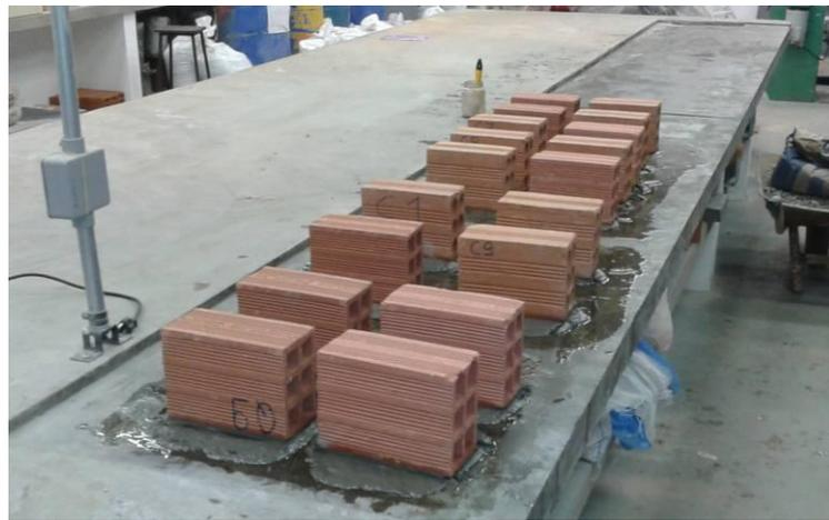
**Figura 12:** Capeamento dos blocos
