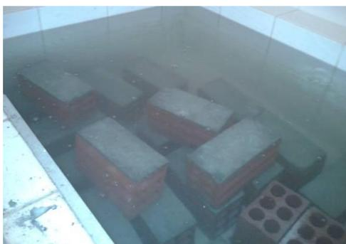
**Figura 14:** Saturação dos blocos
