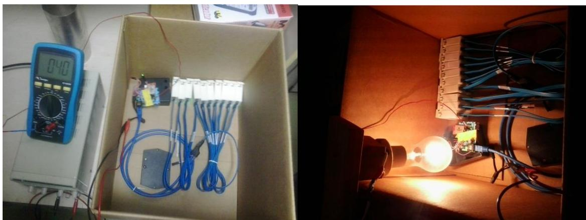
Fotografia 13 – Arranjo do ensaio de temperatura na superfície do circuito.
