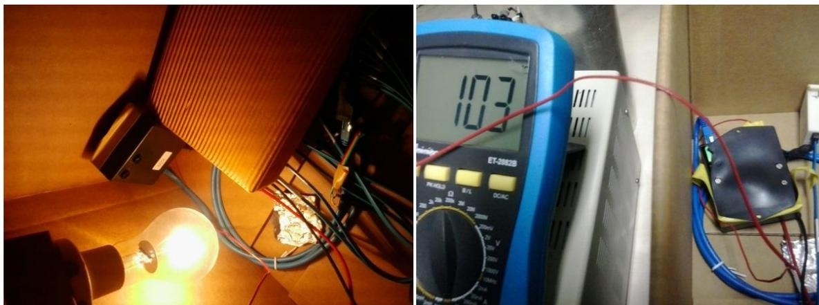
**Fotografia 21 – Aquecimento do circuito e caixa plástica até 103°C**
