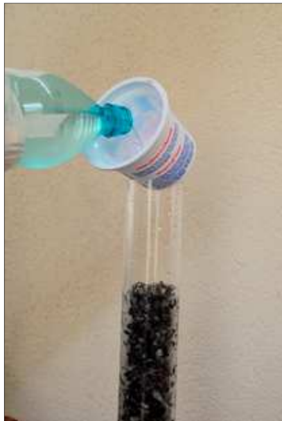
Figura 13 – Processo de filtração – despejo de amostra com o recipiente posicionado
