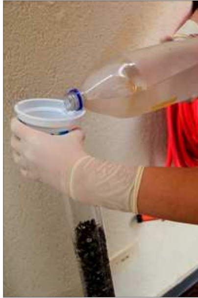
Figura 10 – Processo da filtração – despejo da amostra em recipiente plástico furado
