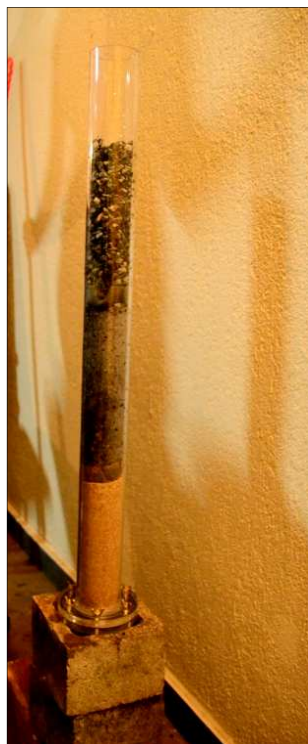
Figura 9 – Filtro 2: filtro de tripla camada
