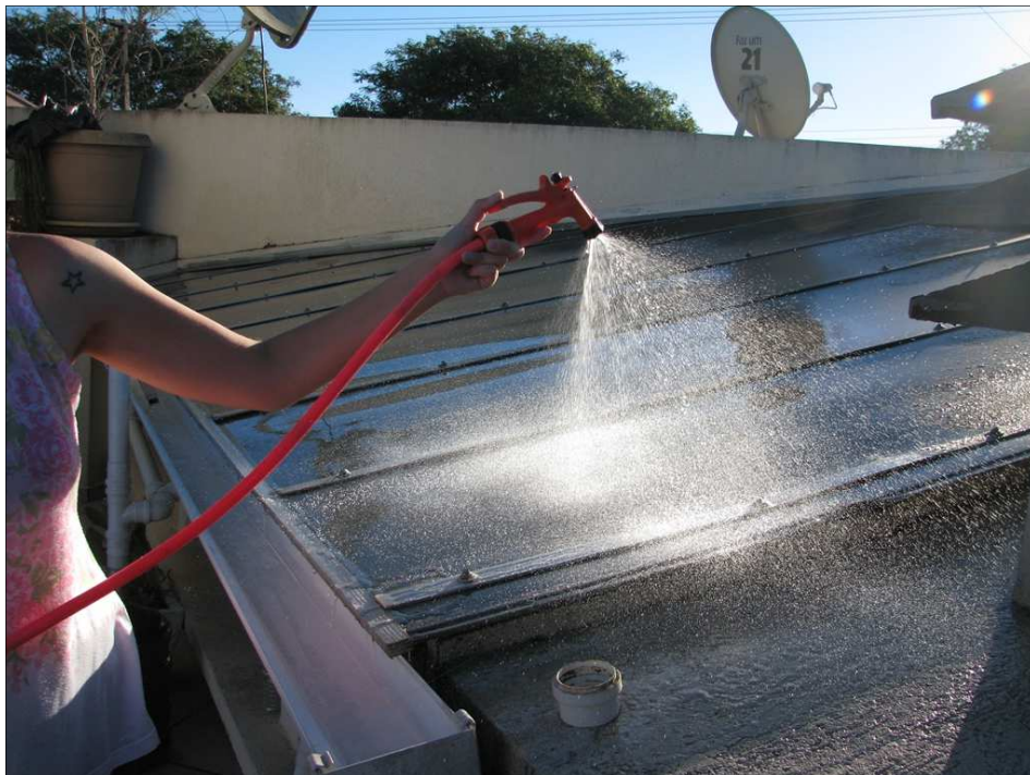
Figura 7 – Simulação da chuva sobre o telhado de captação
