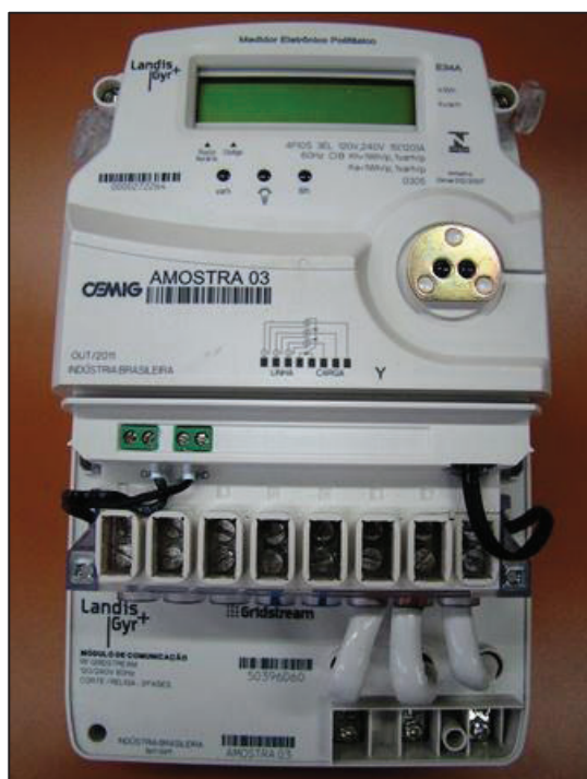
Figura 18 - Medidor de energia bidirecional (smart)
