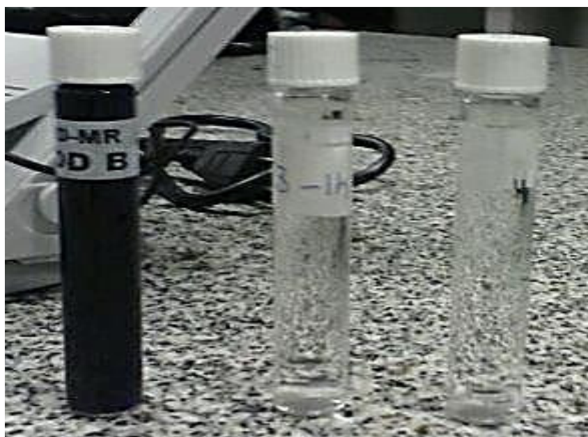
Figura 24 - Comparação entre a solução inicial, a solução após o processo de reação Fenton e água potável da SANEPAR. Fonte: Autoria própria.
