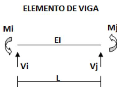
**Figura 13 – Elemento de viga**
