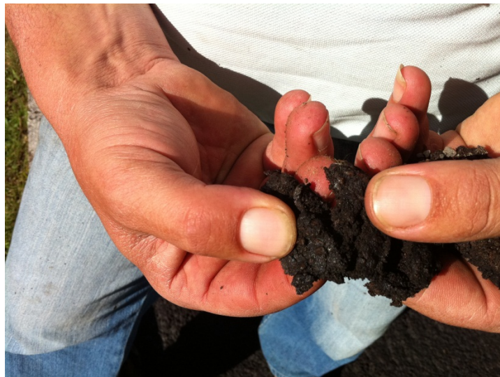
FIGURA 16 - ESTRUTURA FÍSICA DO ASFALTO COM LIGANTE DE BORRACHA FONTE: AUTOR (2011)
