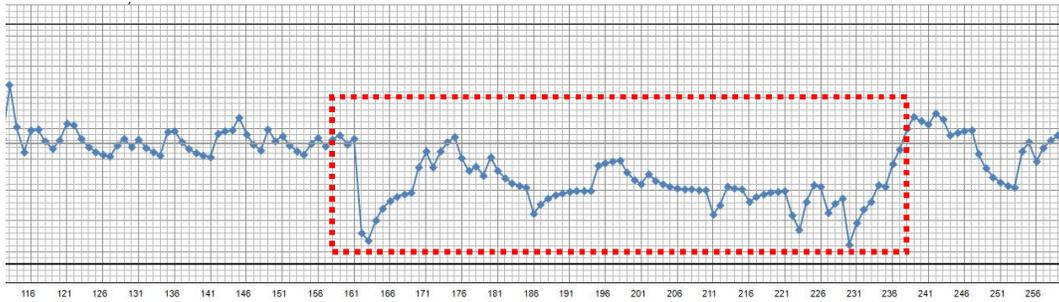
**Gráfico 19** - Detalhe da carta MMEP para a amostra 3 (Processo C) - medições 116 a 260
