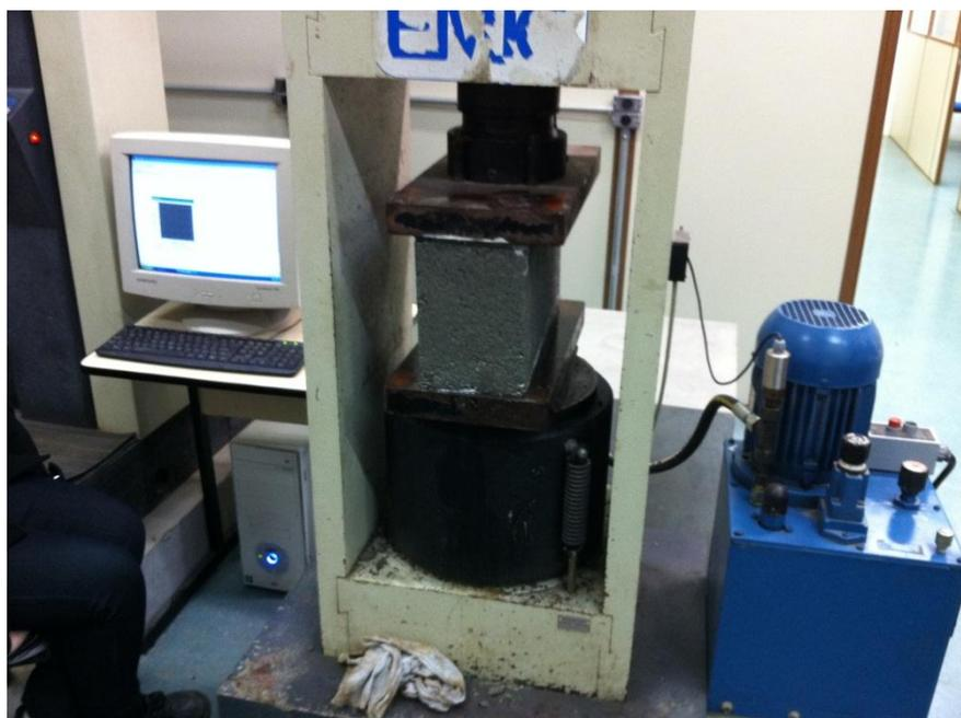
Figura 4.1: Ensaio de resistência à compressão do bloco convencional
