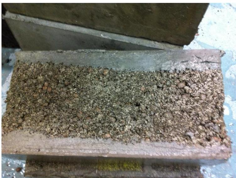
Figura 4.3: Bloco de mistura E: 100% vermiculita e argila
