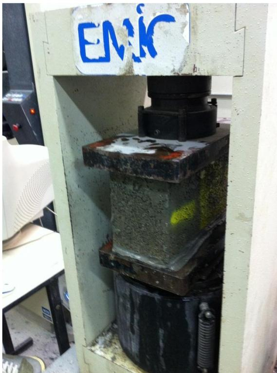
Figura 4.2: Ensaio de resistência à compressão do bloco de mistura B
