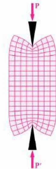
Figura 1: Representação do Princípio de Saint Venant: elemento sob a ação de carga concentrada.
