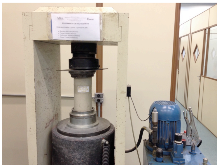
Figura 24 – Prensa utilizada no ensaio de compressão axial. Fonte: Autoria própria.
