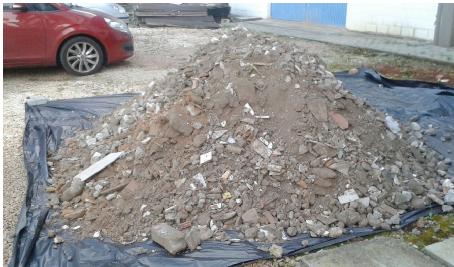
Figura 6 – Pilha de agregado de RCD em estudo. Fonte: Autoria própria.
