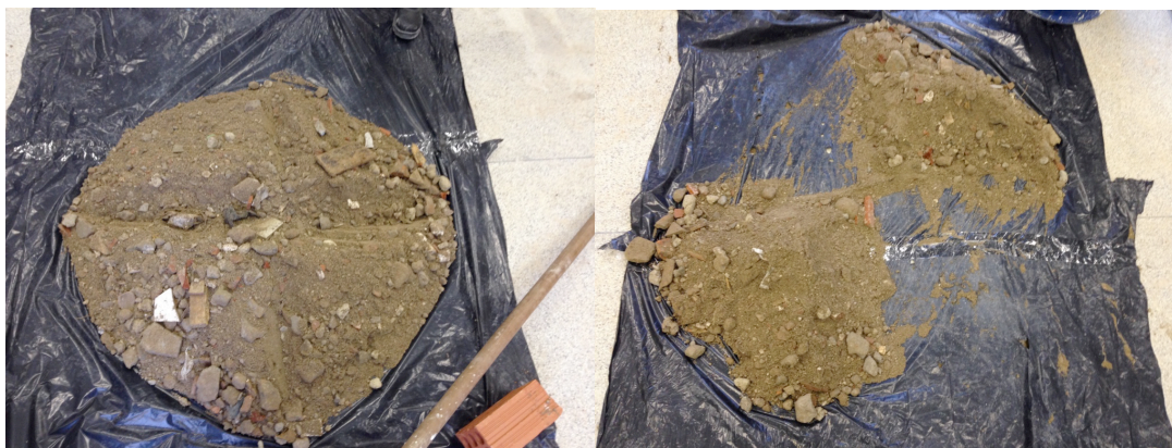
Figura 10 – Quarteamento da amostra de agregado de RCD a ser caracterizado. Fonte: Autoria própria.
