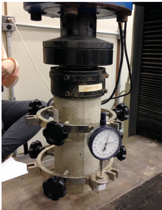
Figura 26 – Prensa e medidores de deformação com bases independentes utilizados no ensaio de módulo de elasticidade estático. Fonte: Autoria própria.
