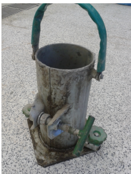
Figura 22 – Molde metálico cilíndrico utilizado para a confecção dos corpos de prova. Fonte: Autoria própria.
