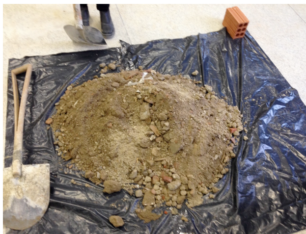
Figura 2 – Amostra de agregado de RCD a ser caracterizado, previamente ao quarteamento.
