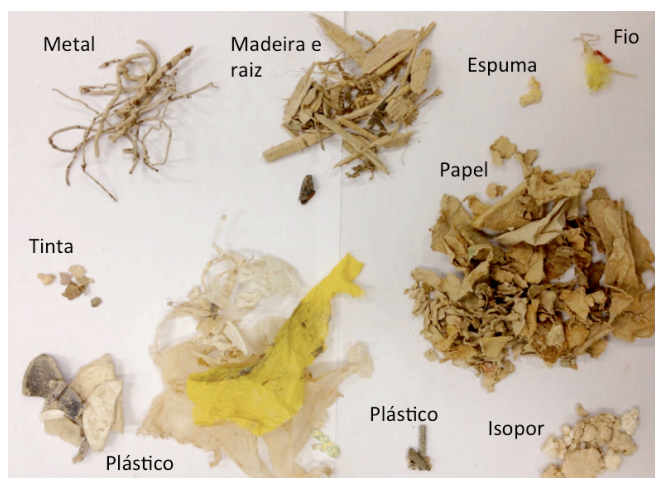
Figura 13 – Contaminantes removidos na triagem da amostra AR Total 1. Fonte: Autoria própria.
