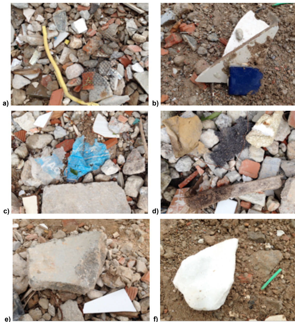
Figura 7 – Detalhamento visual da pilha de agregado de RCD. a) Conduíte e tela plástica. b) Pastilha cerâmica e pedaço de louça sanitárias. c) Sacos plásticos. d) Madeira, espuma, borracha, arame e isopor. e) Revestimento cerâmico, papel e pedaço de concreto de grandes dimensões. f) Granito e capa de fio elétrico. Fonte: Autoria própria.
