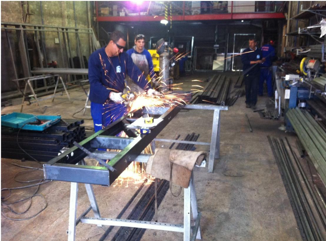
Figura 27: Montagem das Vigas
