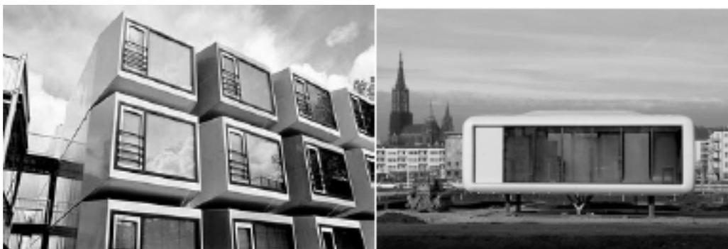
Figura 3. Exemplo de sistemas modulares fechados.
