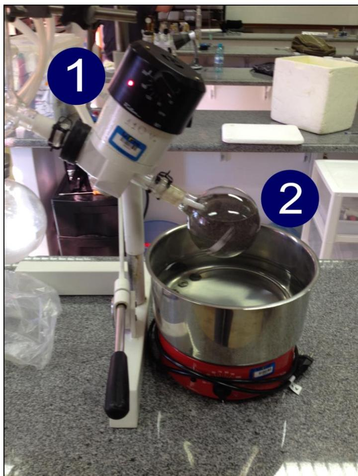
**Figura 8 - Agitação mecânica: 1 - dispositivo de controle de rotação; 2 - balão volumétrico contendo amostra e líquido extrator.**
