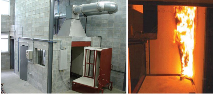
Figura 11 - Ensaio SBI - Single Burning Item de acordo com a EN 13823. Fonte: IPT.
