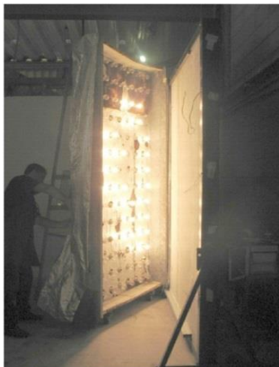
Figura 15 - Painel radiante para ensaio de choque térmico em parede de fachada. Fonte: IPT.
