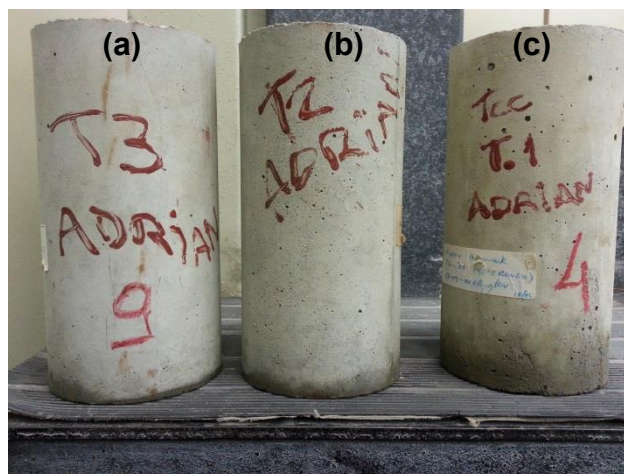
Figura 16 – Absorção de água por capilaridade (a) Traço de Toufar; (b) Traço de Alfred; (c) Traço referência. Fonte: Elaboração do próprio autor
