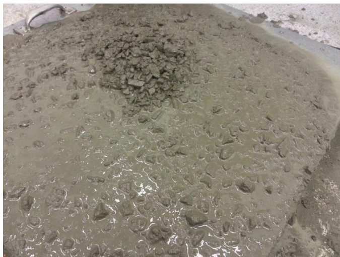
Figura 14 - Produção do concreto a partir do traço pelo modelo de Toufar Fonte: Elaboração do próprio autor
