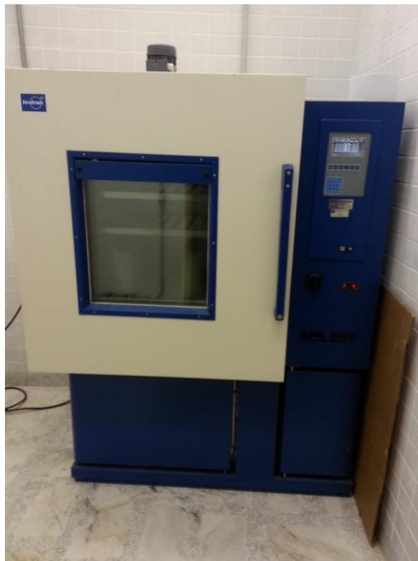
Figura 11 – Câmara de envelhecimento Fonte: Elaboração do próprio autor
