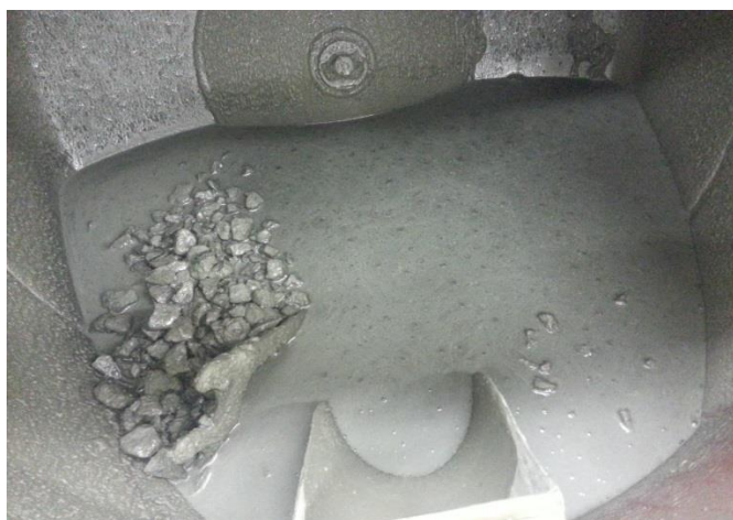
Figura 12 – Produção do concreto a partir do primeiro traço do modelo de Alfred Fonte: Elaboração do próprio autor
