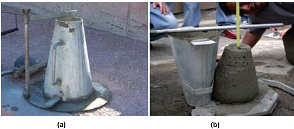
(a) (b) Figura 1– Slump Test : ensaio de consistência (a) equipamento para realizar o ensaio; (b) leitura do ensaio.
