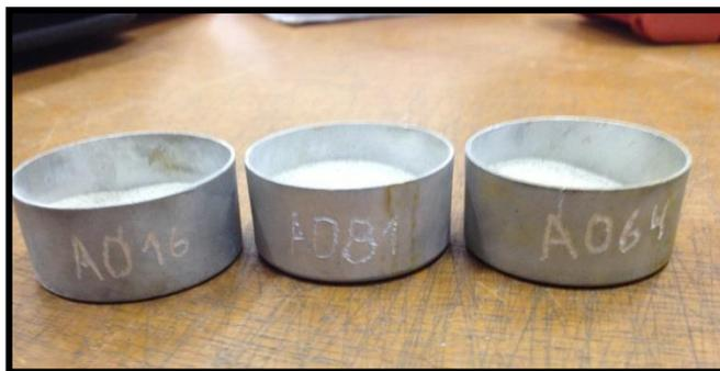
Figura 31 - Cápsulas usadas para ensaio de teor de umidade.
