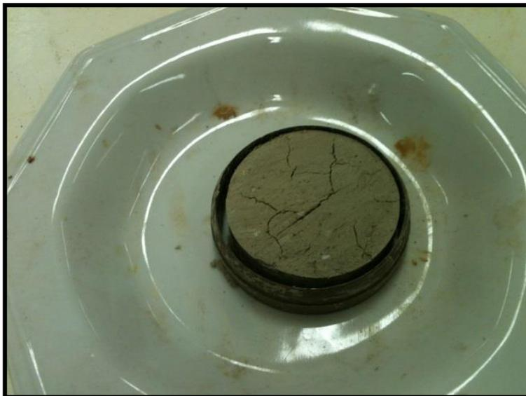
Figura 37 - Amostra de solo após ensaio de contração.
