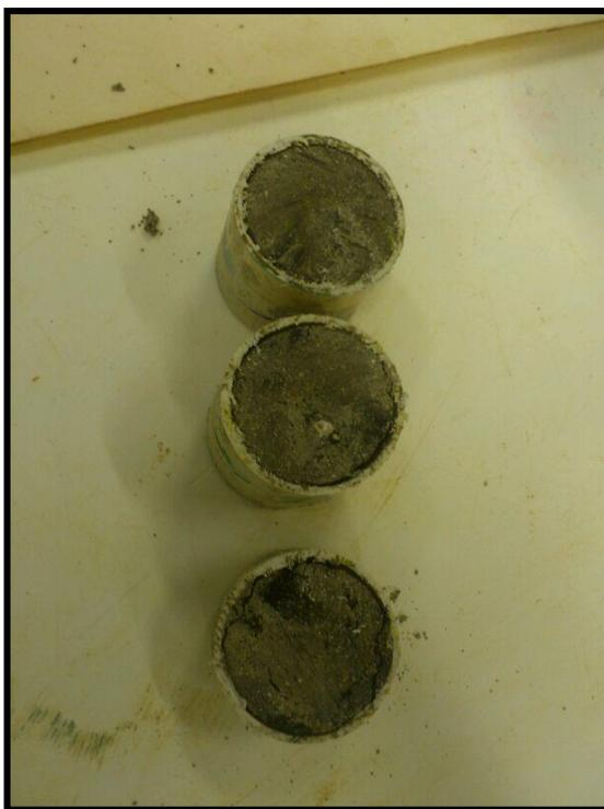
Figura 38 - Amostra de solo indeformada após ensaio de contração.
