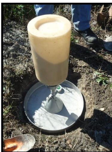
Figura 32 - Ensaio do frasco de areia.
