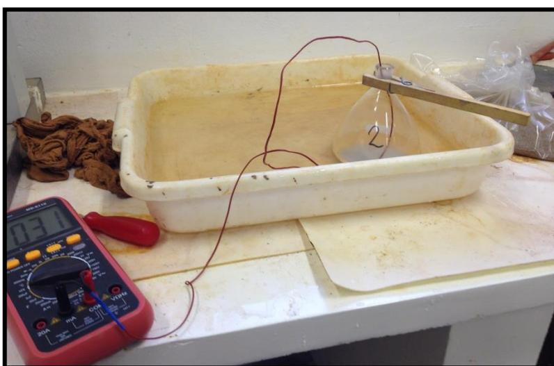
Figura 35 - Ensaio para determinação do peso específico real dos grãos.
