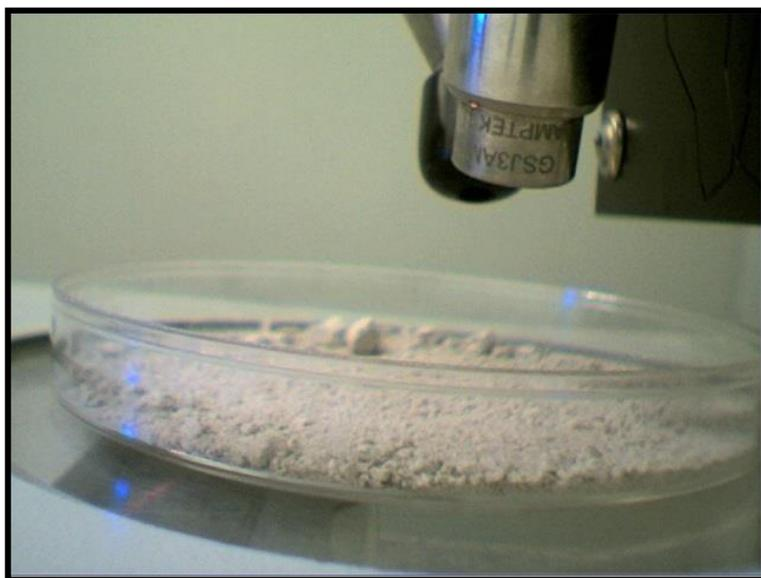
Figura 40 - Ensaio de fluorescência - AMOSTRA A (aterro).
